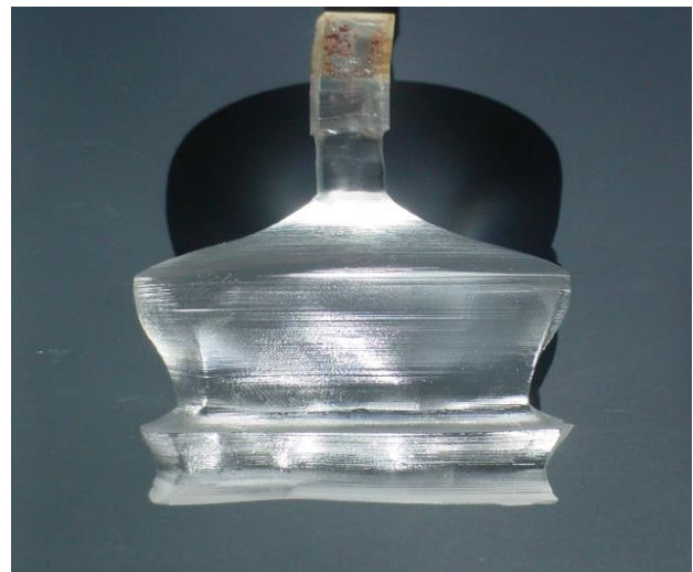
Fig. 1 the grown KCl crystal with 1% nanodiamond doping شکل 1 بلور رشد داده شده KCl با آلیاژ 1% نانوذرات الماس
